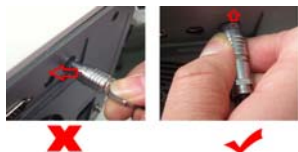
Inserción del conector del pedal de mando
